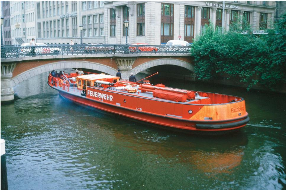
Löschboot „Oberbaurat Schmidt“ passiert mit abgesenktem Ruderhaus die niedrige Straßenbrücke zwischen Binnenalster und Alsterfleet.
